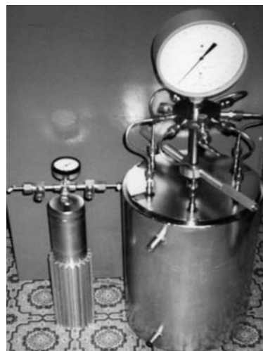
Рис.5. Внешний вид 2 типов аккумуляторов водорода.
