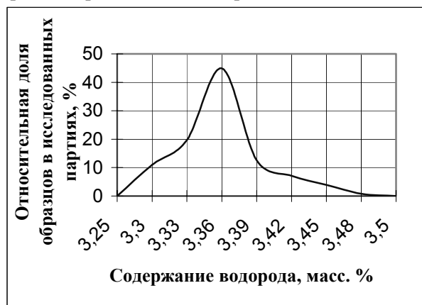
Рис. 1. Содержание водорода в образцах из гидрида титана компактного, полученных в проведенных процессах гидрирования.
